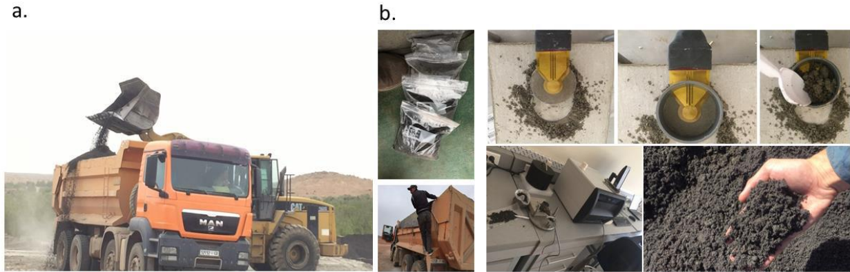
Fig. 5. Etude thermique et physico-chimique des mâchefers de la centrale de Jerada (a) extraction des déchets (b) caractérisation thermique.
